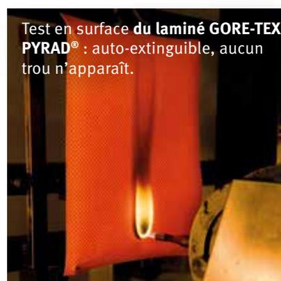
Test en surface du laminé GORE-TEX PYRAD® : auto-extinguible, aucun trou n'apparaît.
