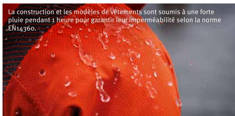
La construction et les modèles de vêtements sont soumis à une forte pluie pendant 1 heure pour garantir leur imperméabilité selon la norme EN14360.
