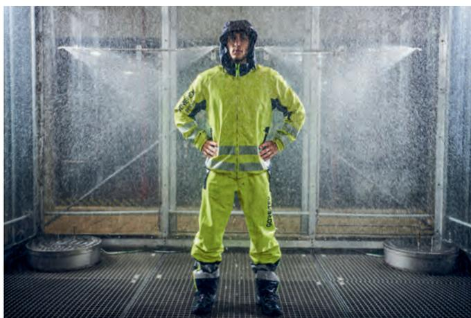
Essais avec exposition à une pluie artificielle
