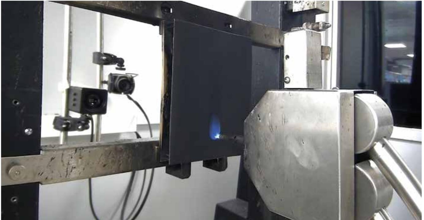
Das EXTRAGUARD Obermaterial entzündet sich nicht, wenn es der Flamme eines Bunsenbrenners ausgesetzt wird (Beflammungszeit 5 Sekunden).
