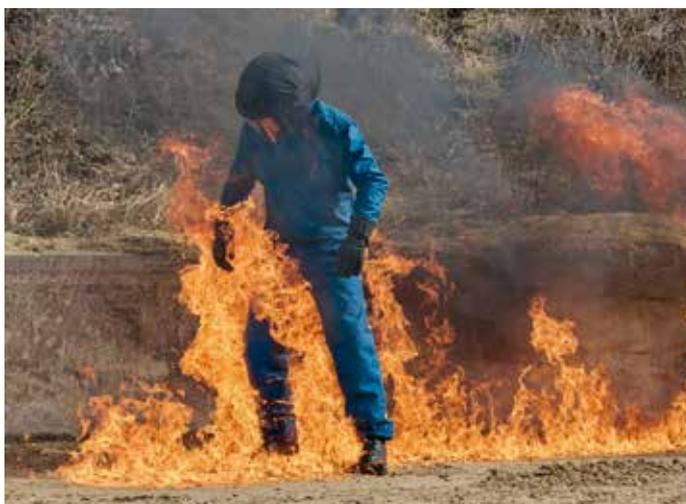
Gore ha condotto test di idoneità all'uso in un ambiente controllato utilizzando stuntmen professionisti e pirotecnici per scopi di ricerca e sviluppo. La tecnologia si è dimostrata in grado di fornire protezione in condizioni simulate per riprodurre i pericoli che si presentano alla polizia antisommossa in situazioni reali.
