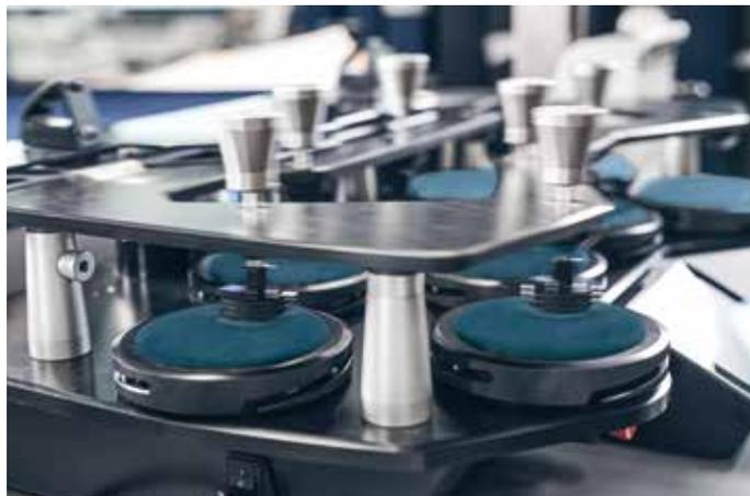
Elevata resistenza all'abrasione nel test Martindale
