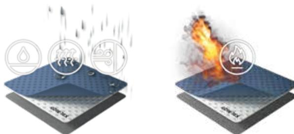
Il materiale e la costruzione dell'indumento sono impermeabili nel tempo, antivento e altamente traspiranti, come dimostrato dal Rain Tower Test (EN 14360) con capi nuovi e con capi lavati in casa (EN ISO 6330, 60°C).
