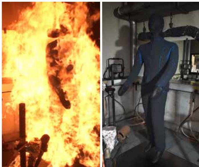
Durante il test un prototipo di tuta GORE-TEX PYRAD® a 3 strati è stato esposto alla fiamma per 4 secondi a 84 kW/m<sup>2</sup>. Non ha mostrato segni di gocciolamento o fusione. Il materiale è rimasto flessibile ed è stato facilmente rimosso senza rompersi. Non c'erano segni di danni agli indumenti sottostanti.
