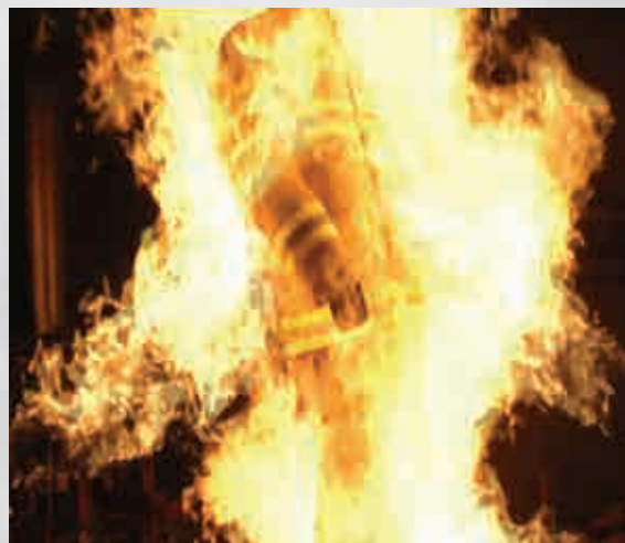
PyroMan, ASTM F1930-15 es un protocolo reconocido en la industria que se utiliza para evaluar el desempeño térmico a NIVEL SISTEMA en situaciones de incendio súbito generalizado. Los resultados se determinan por las propiedades del material y por cualquier movimiento y contracción que se produzca. La exposición de 12 segundos utilizada en la prueba mencionada se considera una situación "grave". La prueba se llevó a cabo en el Centro de Protección y Comodidad Textil de la Universidad Estatal de Carolina del Norte.
